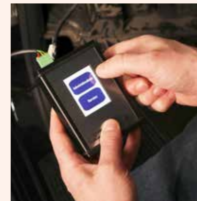
Schritt 5: Für die abschließende Inbetriebnahme und spätere Fehlerauslese ist das abgebildete Diagnosegerät notwendig.
