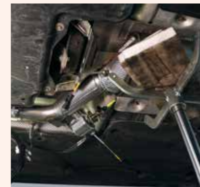
Schritt 3: Danach das neue, vorher zusammen-gesetzte Katalysatormodul einsetzen und befestigen. Entsprechende Halterungen werden mitgeliefert. Anschließend das Dosierventil ausrichten und mit dem Kabel verbinden.
