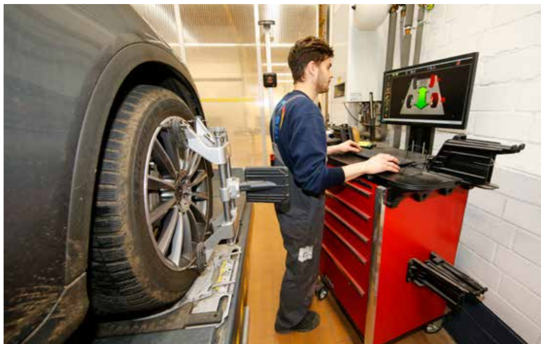
Die Rot-Grün-Darstellung am Monitor schafft schnelle Orientierung. Sowohl beim korrekten Ausrichten der Radklammern (Software zeigt Rot, weil der Monteur und Fotograf zwischen Target und Kamera stehen) als auch bei der eigentlichen Messung danach.
