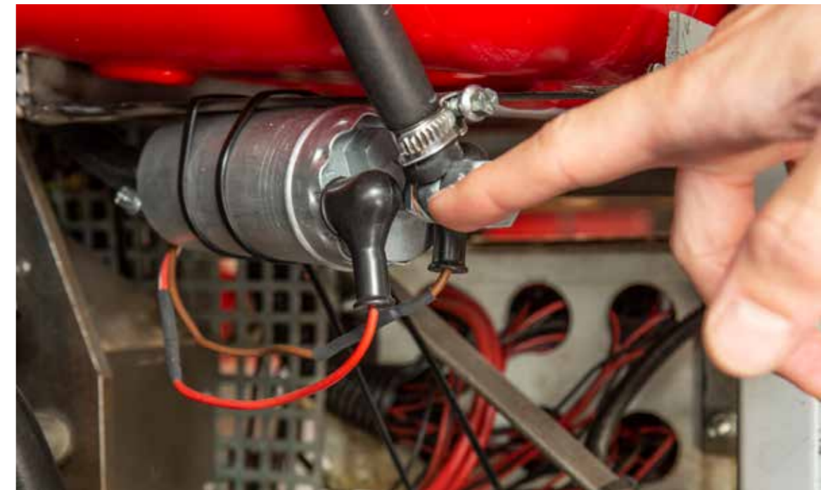
Nicht immer sofort zu finden: Die Hersteller verbauen die elektrische Kraftstoffpumpe in der Regel innerhalb der Tankeinheit. Muss Ersatz her, hilft Teilefinder Katy weiter.
