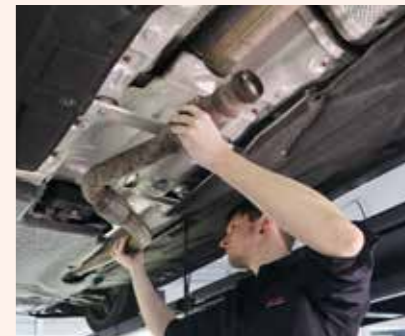
Schritt 3: Danach das neue, vorher zusammen-gesetzte Katalysatormodul einsetzen und befestigen. Entsprechende Halterungen werden mitgeliefert. Anschließend das Dosierventil ausrichten und mit dem Kabel verbinden.
