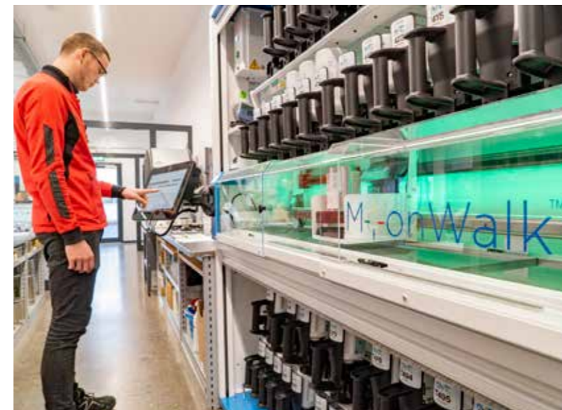
Die MoonWalk wurde im neuen Matthies-Haus aufgebaut. Das automatisierte Farbmischsystem spart Zeit sowie Material und reduziert Fehler.
