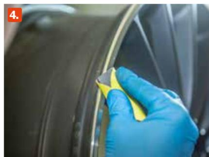
**4. Nach 15 bis 20 Minuten** ist der Vorgang in der Maschine beendet. Der Mitarbeiter korrigiert zwischendurch immer wieder die Einstellungen und schleift am Ende kleine Punkte noch mal nach. Echte Handarbeit.
