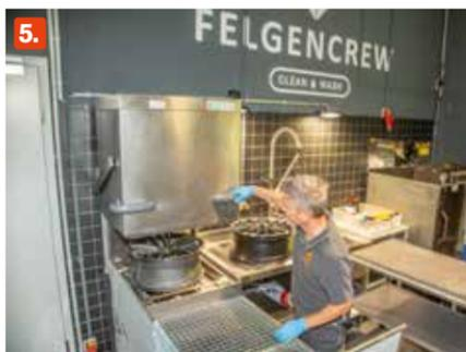
**5. Durch die Bearbeitung** ist die Felge leicht ölig. Daher schaffte sich Fellyfix eine effektive Spülmaschine an, wie man sie aus der Gastronomie kennt. Mittels Tornador werden anschließend störende Partikel weggepusht.
