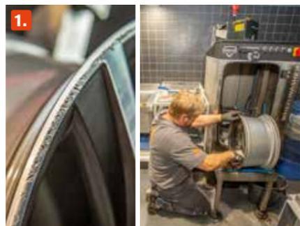
**1. Typische Schäden** der angelieferten Felgen sind vor allem Bordsteinkratzer. Zunächst befreit ein Mitarbeiter die Felge von Dreck und Schmutzpartikeln. Danach folgt noch eine Reinigung in der „Waschmaschine“.
