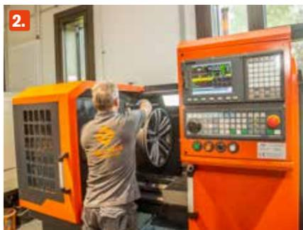
**2. Erst dann** spannt ein Kollege die Felge in die CNC-Maschine ein. Sogar bis zu 30 Zoll große Modelle können bearbeitet werden, das kommt aber selten vor. Zunächst vermisst ein Lasersensor die Felge millimetergenau.
