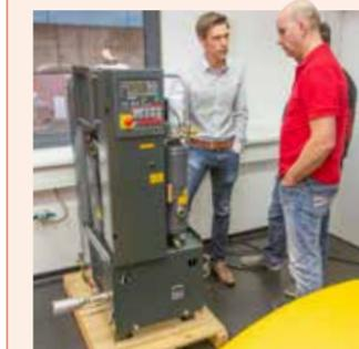
Jean Frederic Westphal (l.) zeigte die Vorteile: Die Kaeser-Schraubenkompressoren arbeiten nicht nur leise. Sie sind auch gerade mal etwas größer als eine Waschmaschine. Und: Ihre Einschaltdauer beträgt 100 Prozent. Das Gehäuse ist abnehmbar.
