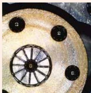
Typisches Schadensbild bei CR-Injektoren: Belagbildung durch Bioanteil. Andere Auffälligkeiten, die auftreten können: Verkockung mangels unzureichender Brennraumtemperatur (viel Kurzstrecke) – oder Korrosion (erhöhter Wasseranteil im Kraftstoff).
