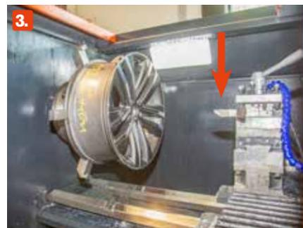
**3. Die Genauigkeit** ist wichtig, da nur ein Millimeter abgeschnitten werden darf. Das Glanzdrehen übernimmt ein spezieller Messerblock (siehe Pfeil). Manche Betriebe arbeiten auch mit Diamant-Schneideinsatz.
