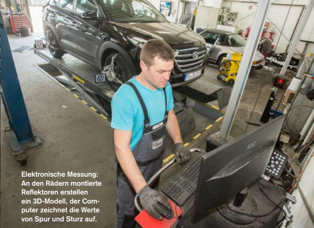
Elektronische Messung: An den Rädern montierte Reflektoren erstellen ein 3D-Modell, der Computer zeichnet die Werte von Spur und Sturz auf.
