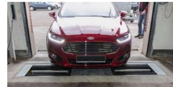
Einfahrt neue Halle. Der extrabreite Rollenprüfstand nimmt auch große Fahrzeuge auf und gibt die Werte über ASA-Livestream direkt an den HU-Adapter. Rechts: Vorbereitung 3D-Messung.
