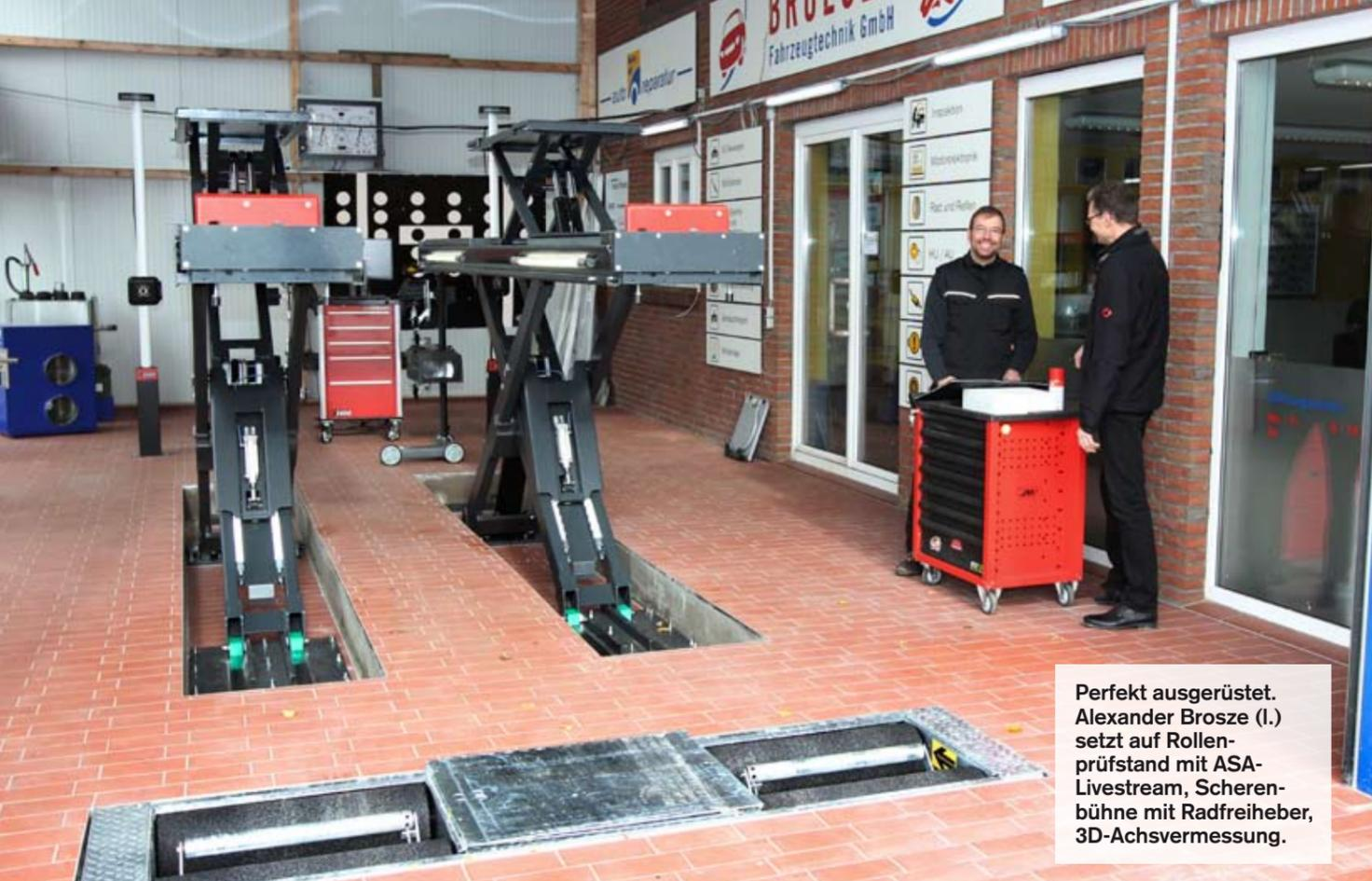
Perfekt ausgerüstet. Alexander Brosze (l.) setzt auf Rollenprüfstand mit ASA-Livestream, Scherenbühne mit Radfreiheber, 3D-Achsvermessung.
