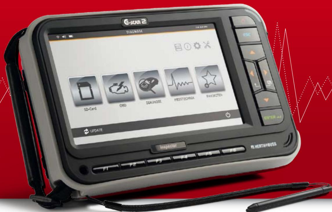
Der Inspector ist ein speziell für asiatische Fahrzeugmodelle entwickeltes Multimarken-Diagnosegerät mit dem Schwerpunkt auf asiatischen Kfz und Nfz. Er unterstützt Sie sowohl bei anspruchsvoller Diagnose als auch bei allen Wartungs- und Reparaturarbeiten. Zudem überzeugt der Inspector mit vielen praktischen Features wie die automatische Systemsuche, Gesamtanfragen, Screenshot- und Vermerk-Funktion, Favoriten-Funktion und einiges mehr. Eben ein Champion für Asiaten!
