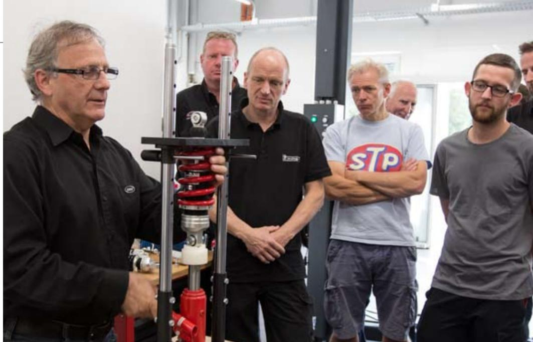
Fast wie beim Auto: Die Feder in Monoshocks steht unter hoher Vorspannung, ohne Federspanner geht da nichts. Zusätzlich darf kein Kratzer drankommen, da sind Motorradfahrer eigen.
