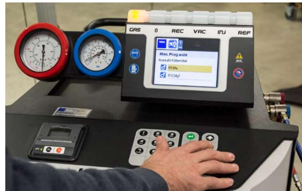
Bis jetzt wurden für das alte Kältemittel R134a und das neue R1234yf zwei Servicegeräte benötigt. Das Texa Konfort 780R Bi-Gas kann beide.
