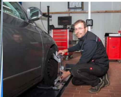
Alexander Brosze mit 3D-Reflektor (l.). Achsvermessung wird immer wichtiger, so brauchen Assistenzsysteme für die Kalibrierung ein exakt eingestelltes Fahrwerk. Bild Mitte: Werkstatt. Rechts: Der Bauherr berät sich mit Gerald Fuhlbohm, Matthias Heide.
