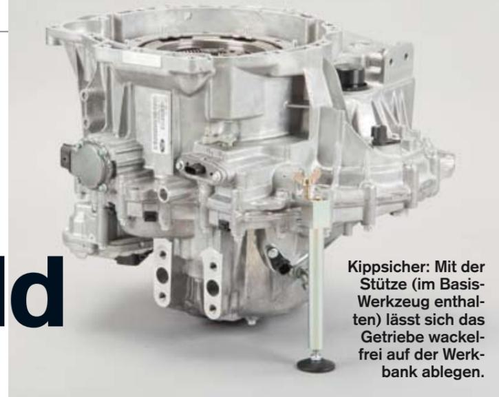
**Kippsicher:** Mit der Stütze (im Basis-Werkzeug enthalten) lässt sich das Getriebe wackelfrei auf der Werkbank ablegen.
