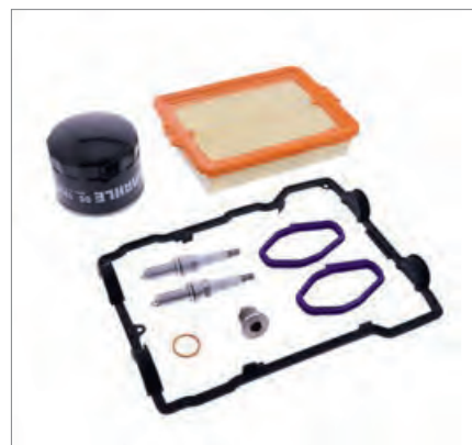
Service-Kit: Solch typische Verschleißteile liegen neu und montagefertig im Set.
