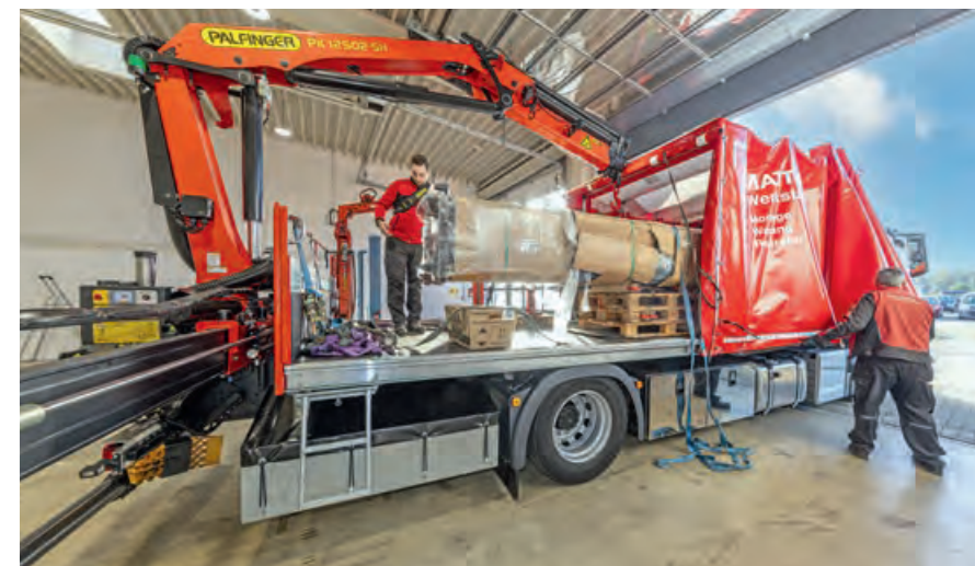
Besonderheit: Das Schieberverdeck ermöglicht barrierefreies Arbeiten. Der neue Lkw trägt sogar knapp eine Tonne mehr als sein Vorgänger (6,5 Tonnen Nutzlast).
