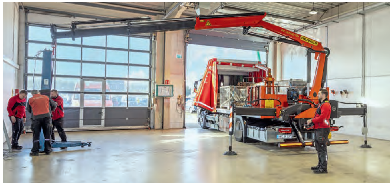
Präzision: Bei Hartmann mussten zunächst die Elemente der alten Bühne abgebaut und umgesetzt werden. Mit dem Aufbaukran des neuen Lkws kein Problem. Durch seinen kleinen Wendekreis und die niedrige Bauhöhe ist das speziell für Matthies konzipierte Fahrzeug flexibel einsetzbar.
