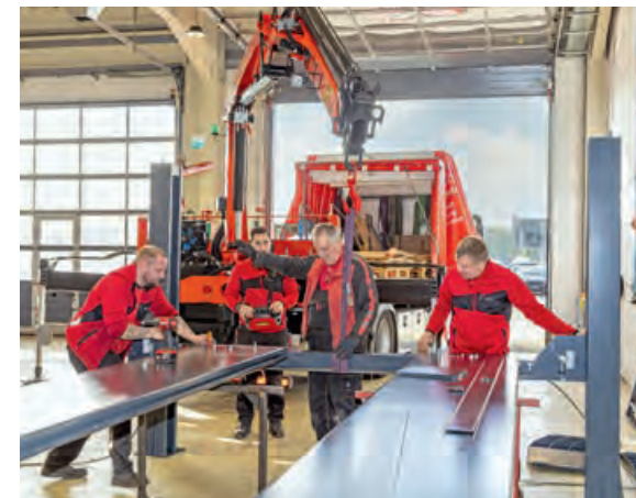
Teamwork: Nachdem die schweren Bauteile abgesetzt sind, übernehmen die beiden Techniker die Montage der JMP Fox 5500 H (r.). Die Viersäulenbühne trägt fünfeinhalb Tonnen und ist zur Aufnahme von Pkws, aber auch schweren Transportern und Wohnmobilen geeignet.
