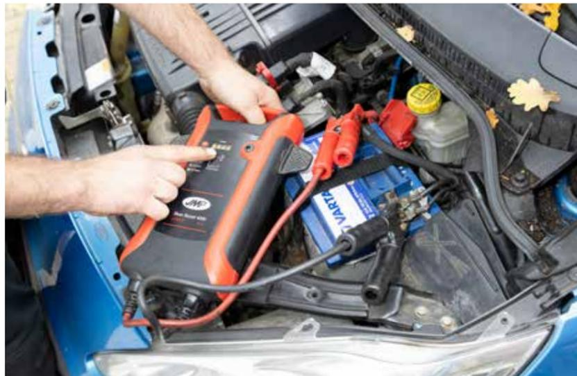
**Effektive Starthilfe:** Für Pkws genügt das JMP Skan Boost 4000. Macht aber der Akku eines Lkws oder Busses schlapp, helfen die 10.000 Ampere des neuen Geräts schneller weiter.
