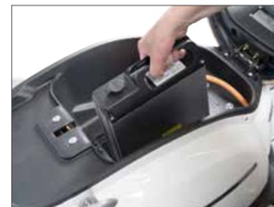
**Platz für zwei Akkus:** Die herausnehmbare Batterie steckt unter der Sitzschale.
