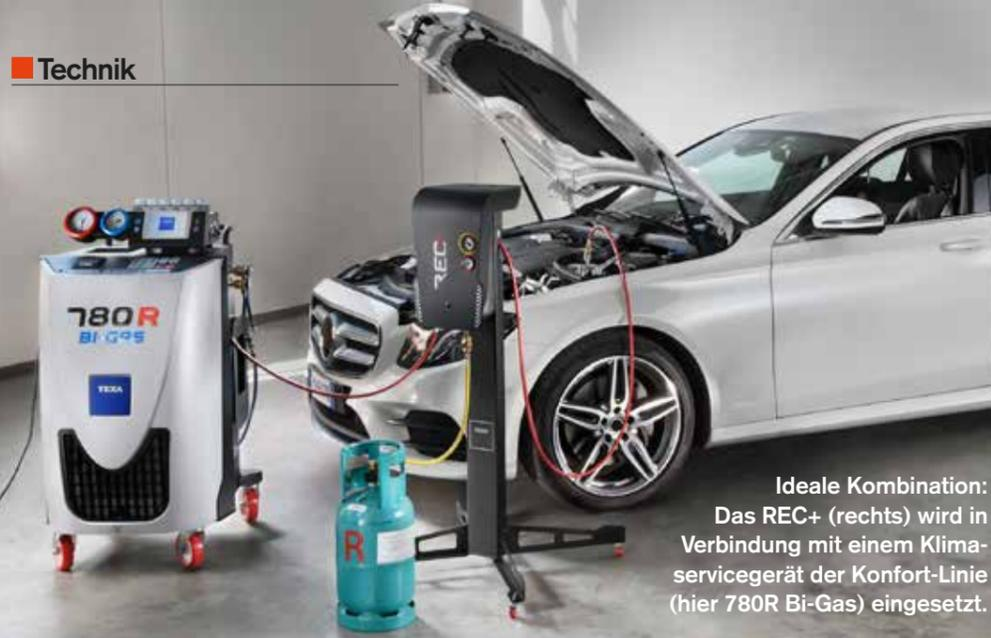
Ideale Kombination: Das REC+ (rechts) wird in Verbindung mit einem Klimaservicegerät der Komfort-Linie (hier 780R Bi-Gas) eingesetzt.
