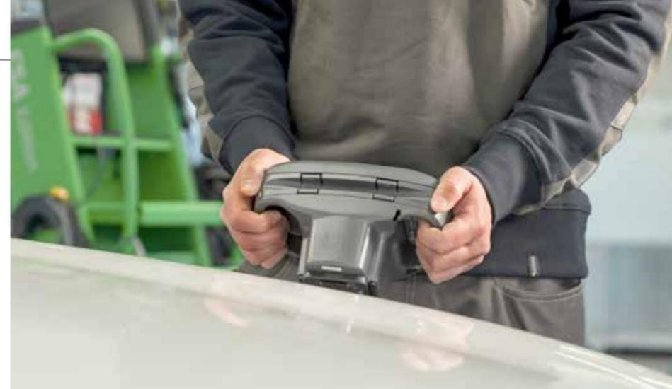
Vor der Verwendung muss das Gerät kurz kalibriert werden. Den Messpunkt (etwa eine Schadensstelle) sollte der Mitarbeiter vorher am besten gründlich reinigen.
