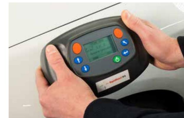
Die Messung besteht aus fünf Durchgängen, um Fehlanalysen auszuschließen. Bei Matthes wird das Gerät anschließend ausgelesen und die Farbe angemischt.
