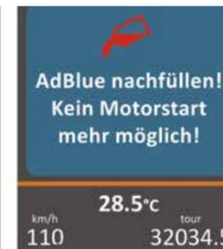
Wenn AdBlue nicht rechtzeitig aufgefüllt wird, geht das Fahrzeug in den Notlauf. Tipp für das Verhalten bei der Anzeige rechts: Motor nicht abstellen! Bis zur Tankstelle oder Werkstatt fahren.
