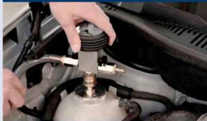
**Kühler-Vakuumbefüllgerät mit Schnellkupplung**
