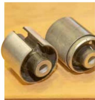
Der Name Schlitzbuchse kommt vom offenen Ring, der die korrekte Vorspannung garantiert.
