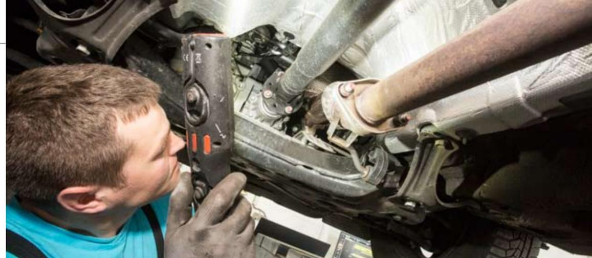
Einzel- statt Komplettaustausch: Bisher musste bei einem defekten Mittelwellenlager häufig die ganze Kardanwelle ersetzt werden. Nun gibt es günstige Alternativen.
