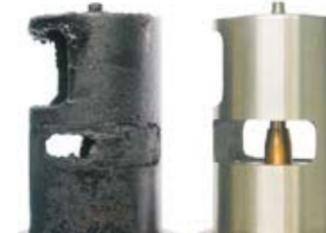
Vergleich: ein verrostetes elektrisches AGR-Ventil, rechts neu.
