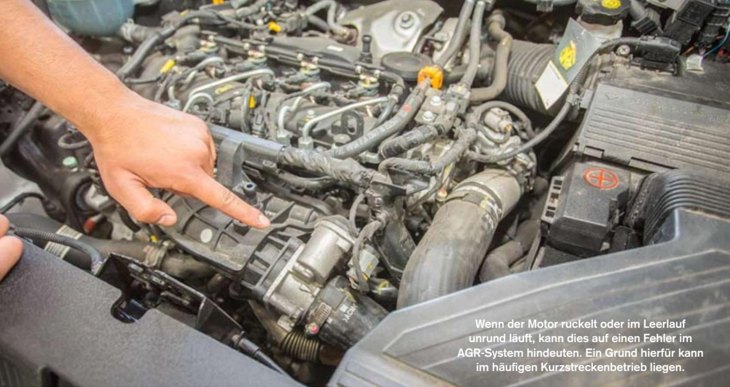
Wenn der Motor ruckelt oder im Leerlauf unruhig läuft, kann dies auf einen Fehler im AGR-System hindeuten. Ein Grund hierfür kann im häufigen Kurzstreckenbetrieb liegen.
