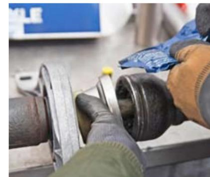
**5. Schritt:** Gelenkfett zum Schmieren des Gelenks verwenden (dieser Schritt wird gerne unterschätzt). Das Fett ist bereits im Kardanwellen-Reparaturatz enthalten. Nach dem Fetten die Kardanwelle zusammenstecken und auf Funktion prüfen.
