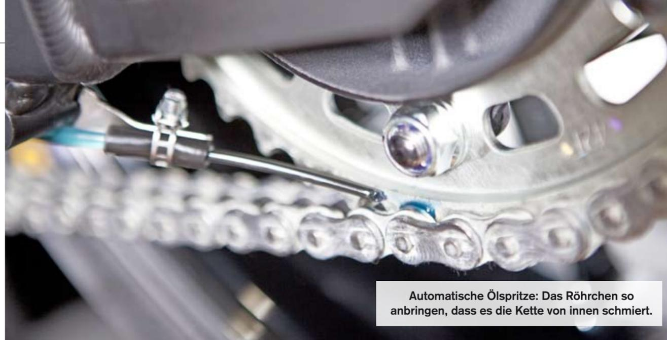
Automatische Ölspritze: Das Röhrchen so anbringen, dass es die Kette von innen schmiert.
