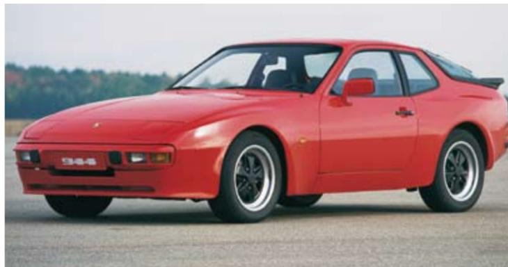
Das gefragteste Modell: 944 in seiner Urfassung von 1982. Verbreiterte Karosserie und ebensolche Spurweite für verbessertes Handling; den Antrieb besorgt nun endlich ein echter Porsche-Motor – der halbierte Achtzylinder aus dem 928, 163 PS.
