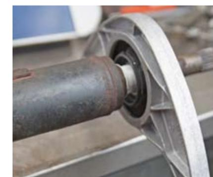
**3. Schritt:** Das neue Mittelwellenlager vorsichtig aufbringen. Die Reparatursätze eignen sich für über zehn Millionen Fahrzeuge von Herstellern wie Audi, Seat, Skoda, VW, Porsche und Mercedes-Benz.
