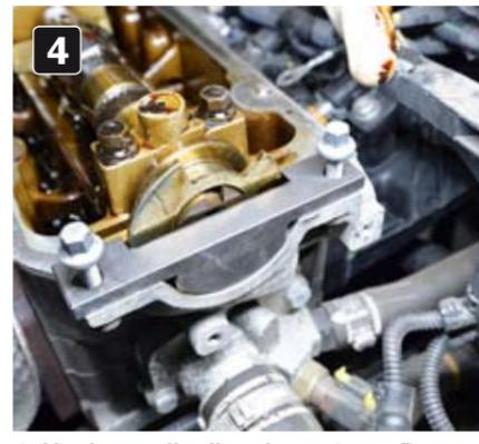
**4. Nockenwellenlineal ansetzen:** Das Blockierwerkzeug – beispielsweise aus dem Motorset Fiat (JM-Nr. 614 06 27) – einschieben und mit zwei Schrauben des Ventildeckels befestigen. Falls noch nicht geschehen, nun Kühlwasser ablassen.
