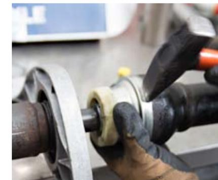
**6. Schritt:** Befestigung der Schutzkappe durch Umkanten. Auch hier: vorsichtig vorgehen. In den Kits sind alle für den Wechsel des Mittelwellenlagers benötigten Komponenten wie Lager, Klemmring, Manschette, Befestigungsmaterial und Fett beigelegt.
