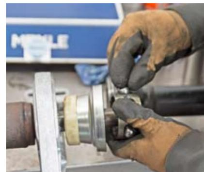
**4. Schritt:** Die Gelenkkugeln wieder in die zuvor an Innen- und Außenverzahnung markierten Laufbahnen einsetzen. Wer unsicher ist, blickt vorher in die ausführliche Einbauanleitung oder schaut sich das entsprechende Erklärvideo an.
