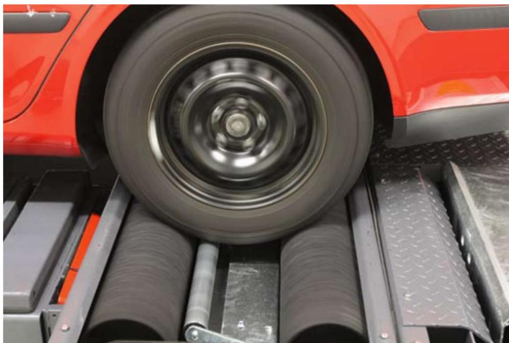
Neben marginalen Änderungen an Prüfgeschwindigkeit, Schlupf oder Rollendurchmesser ist vor allem die ASA-Livestream-Schnittstelle eine maßgebliche Neuerung. Sie gilt für alle Prüfstände.
