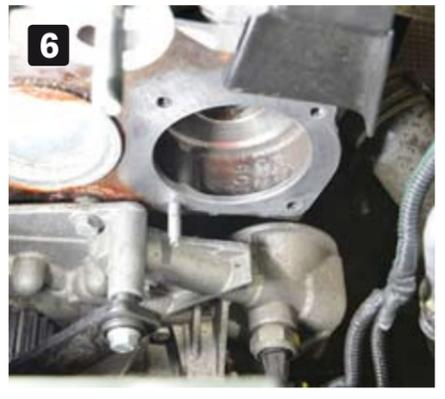
**6. Pumpe erneuern:** Es empfiehlt sich, bei diesen Motoren die Wasserpumpe gleich mit zu erneuern. Dazu die Dichtfläche sorgfältig reinigen und entfetten, denn es dürfen später keine Wassertropfen zurückbleiben.
