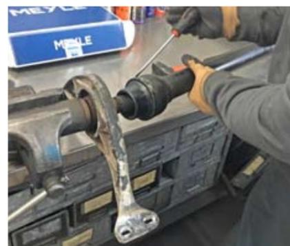
**1. Schritt:** Kardanwelle ausbauen, Kappe entfernen. Vorsichtig vorgehen, um Herausfallen der Kugeln zu vermeiden. Position vom Kugelgelenk auf Welle markieren, um es später an gleicher Position zu montieren.
