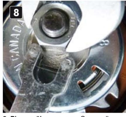
**8. Riemen überspannen:** Spannrolle vorsichtig bis zum Anschlag bewegen, mit 25 Nm festziehen. Blockierwerkzeuge entfernen, Kurbelwelle zwei Umdrehungen durchdrehen, Steuerzeiten prüfen.
