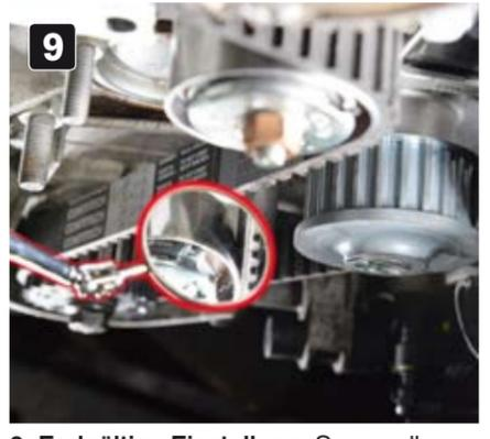
**9. Endgültige Einstellung:** Spannrolle lösen, bis Zeiger und Bezugsmarke fluchten. Festziehen, Motor durchdrehen und Stellung der Spannrolle erneut prüfen. Passt es, Motor komplettieren, Probefahrt.
