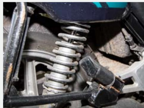
**Normalzustand.** Die hinteren Federbeine der Honda CB 500 sind noch die Erstausrüstung von 1995. Spürbare Dämpfung findet kaum noch statt, die Maschine schwimmt mehr, als sie fährt.
