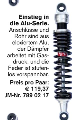
**Einstieg in die Alu-Serie.** Anschlüsse und Rohr sind aus eloxiertem Alu, der Dämpfer arbeitet mit Gasdruck, und die Feder ist stufenlos vorspannbar.
