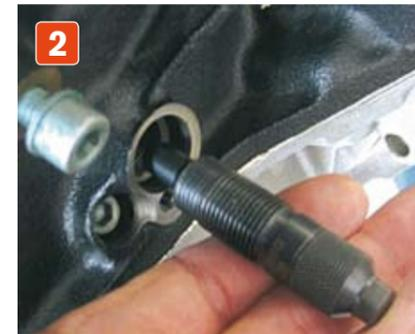
**Kurbelwelle blockieren.** Verschlussstopfen aus dem Kurbelgehäuse entfernen und das Fixierwerkzeug aus dem Motorsatz einsetzen. Es muss sich widerstandlos eindrehen lassen. Andernfalls Lage der OT-Bohrung in der Kurbelwange prüfen.
