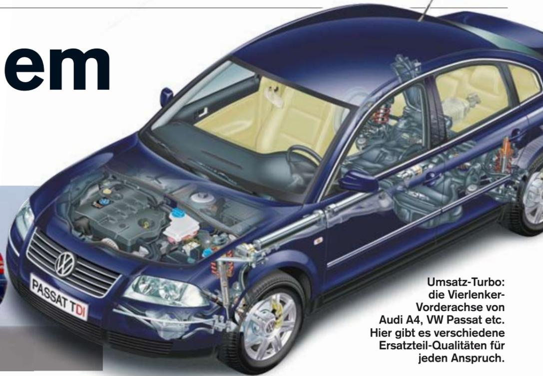
Umsatz-Turbo: die Vierlenker-Vorderachse von Audi A4, VW Passat etc. Hier gibt es verschiedene Ersatzteil-Qualitäten für jeden Anspruch.
