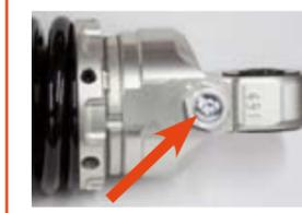
**Sensible Schraube.** Achtung: Dahinter befindet sich das Ventil für die Gasfüllung. Bei falschem Vorgehen kann Gas entweichen. Neubefüllung ist natürlich möglich.
