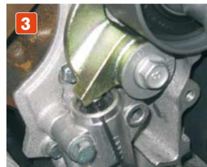
**Nockenwellen fixieren.** Neuen Riemen auflegen, Nockenwellenräder abziehen und wieder so weit festziehen, dass sie sich noch leicht auf den Wellen verdrehen lassen, anschließend Nockenwellen-Fixierwerkzeug anbringen.
