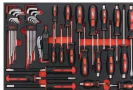
**Die Schraubendreher-Abteilung:** Außerdem lagern hier Inbus in Sechskant und Torx mit Kugelkopf sowie ein Poltester.
