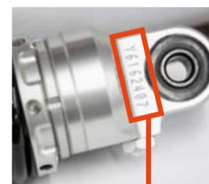
**Eingelasert:** Teile mit ABE tragen die Nummer gut sichtbar am oberen Auge.
