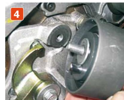
**Spannrolle entfernen.** Den Exzenter der Spannrolle vom Kurbelgehäuse abschrauben. Auf die Distanzscheibe achten, diese muss bei Montage einer neuen Spannrolle übernommen werden. Anschließend den alten Zahnriemen abnehmen.
