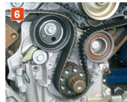
**Neuen Riemen vorspannen.** Nun Sicherung des Hydraulikspanners entfernen und den Exzenter der Spannrolle mit 15 Nm vorspannen, dann Nockenwellenräder mit 55 Nm festziehen. Fixierwerkzeug und Kurbelwellensicherung entfernen.
