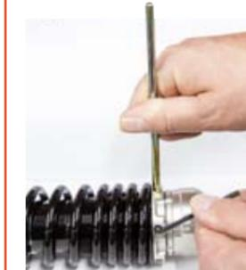
**Madenschraube.** Sie ist mit Gummi beschichtet. Vor dem Verstellen der Federbasis unbedingt lösen, sonst verklemt sie sich im Gewinde.
