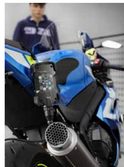
Diagnose im Stand oder während der Fahrt: Beides ist mit dem Navigator TXB 2 möglich.
