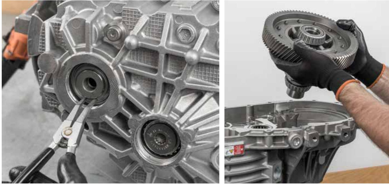
Für die Reparatur des Getriebes muss zunächst der Deckel abgenommen werden, damit der Monteur an die Verschraubung und den unteren Klemmring kommt. Wenn beides gelöst ist, lassen sich die Gehäuseschrauben öffnen und die Lager des Getriebes wechseln.
