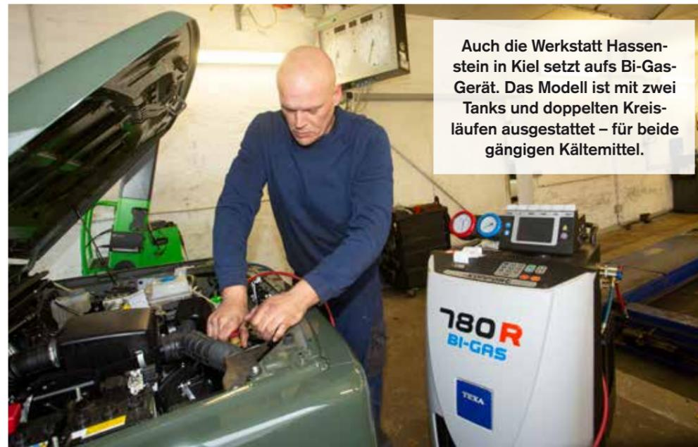
**Auch die Werkstatt Hassenstein in Kiel setzt aufs Bi-Gas-Gerät. Das Modell ist mit zwei Tanks und doppelten Kreisläufen ausgestattet – für beide gängigen Kältemittel.**
