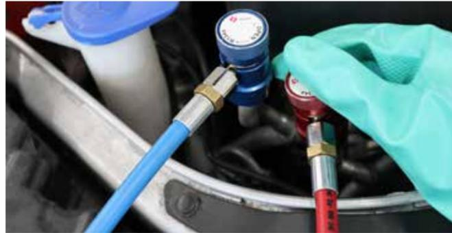
Bevor das Servicegerät angeschlossen wird, sollte der Monteur wichtige Bauteile und Dichtungen prüfen – sowie Schläuche kontrollieren. Diese können altern und undicht werden.
