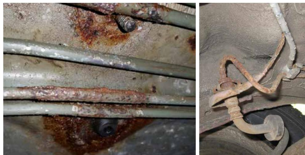
Feindbild Rost: Stellt der Prüfer bei der Hauptuntersuchung Korrosion an der Bremsleitung fest, gibt's keine Plakette. Die Reparatur der Stahlmodelle ist kompliziert und zäh.
