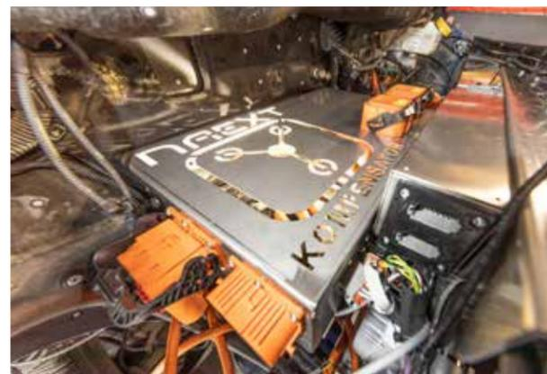
Links: das futuristische Antriebsmodul. Im Kompensator stecken die Steuergeräte. Für den Einbau können Monteure vorhandene Befestigungspunkte nutzen. Rechts: Vorbereitungen für die Akku-Installation. Realistische Reichweite: 250 bis 300 Kilometer.
