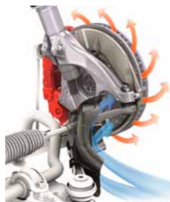
Prinzip Wasserpumpe: Die Scheibe schleudert die warme Luft weg.
