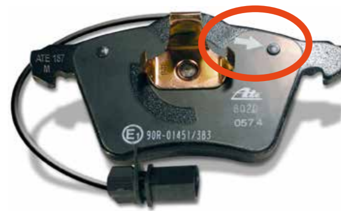
Hat beides: ATE-Belag mit Pfeil für die Scheiben-Drehrichtung und einer kleinen Aussparung in der Beschichtung der Rückenplatte.
