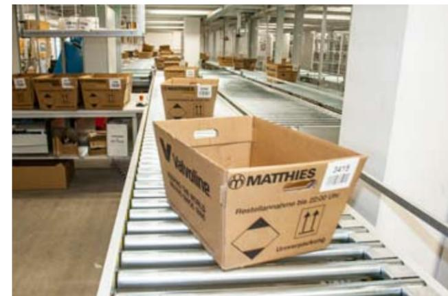
Ausgeklügeltes System: Per Barcode-Scan und Waage prüft das intelligente Förderband automatisch, ob die bestellte Ware korrekt verpackt wurde und wohin sie verschickt wird.
