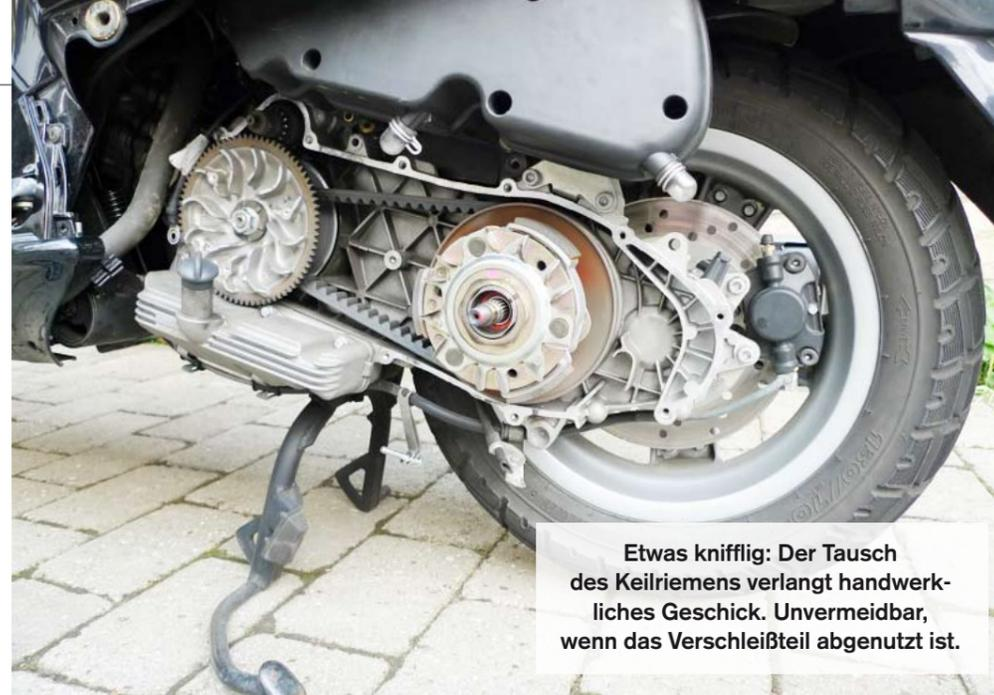
Etwas knifflig: Der Tausch des Keilriemens verlangt handwerkliches Geschick. Unvermeidbar, wenn das Verschleißteil abgenutzt ist.
