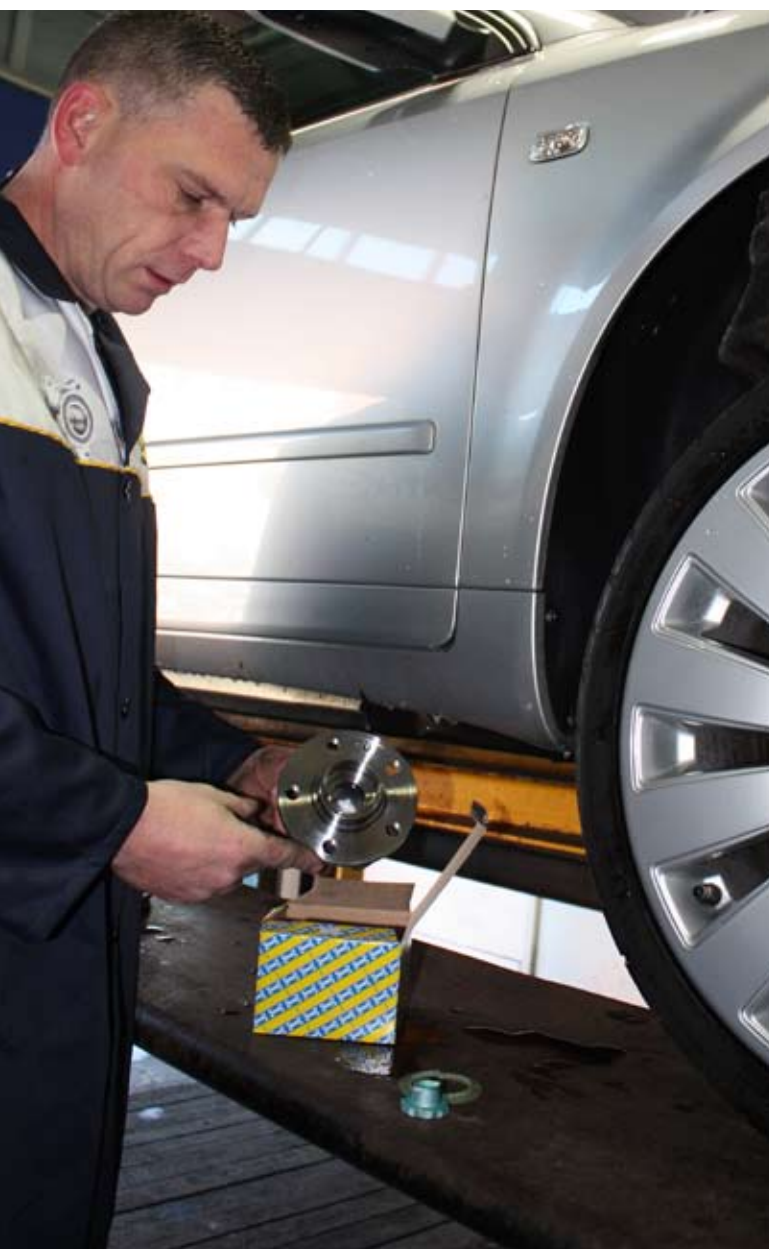
Sensibel: ASB-Lager. Um Beschädigungen vor allem des Magnet-Encoders zu vermeiden, erst kurz vor dem Einbau auspacken.
