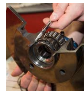
Typisch französisch: Lager in Bremsscheibe integriert.
