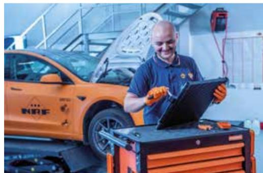
NRF Technik-Trainer Przemyslaw Czapski hat beim Tesla Model 3 den Original-Kondensator gegen eine NRF-Nachrüstversion ausgetauscht.
