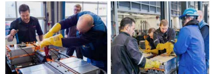
**Schritt für Schritt:** Die Kfz-Profis öffnen vorsichtig den Deckel (o.). Trainer Philipp Benstein (unten links) beobachtet die Messungen, danach werden einzelne Module losgeschraubt.
