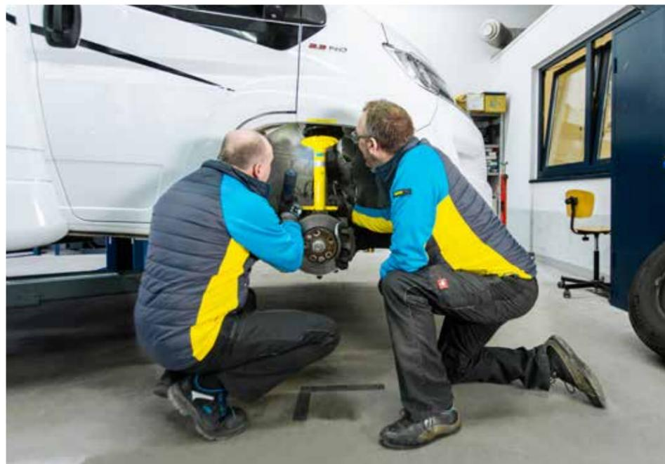
**Besseres Fahrverhalten:** Mit den neuen Hochleistungsstoßdämpfern lassen sich Komfort und Sicherheit erhöhen. Die Dämpfungseigenschaften wurden zuvor in vielen tausend Stunden speziell auf die Parameter von Wohnmobilen abgestimmt.
