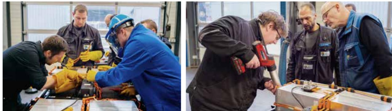
**Fast geschafft:** Nachdem die Batterieelemente wieder im Gehäuse liegen, müssen sie noch neu verkabelt werden (l.). Eine konzentrierte Fleißarbeit. Danach verklebt ein Mitarbeiter den Deckel, bevor er zugeschraubt und die Antriebsbatterie wieder ins Fahrzeug eingesetzt wird.
