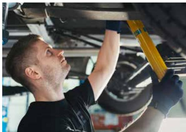
hinaus über die sogenannte DampMatic-Technologie – eine automatische Dämpfungskraftverstellung, die das Fahrzeug stets stabil hält. Diese stellt sich je nach Situation automatisch auf eine von zwei Kennlinien ein, sodass die Kunden quasi zwei Stoßdämpfer in einem bekommen – und das ganz ohne komplexe und teure Elektronik. „Der B6 Camper Advanced besitzt eine weiche Kennung beim Cruisen und eine straf-
