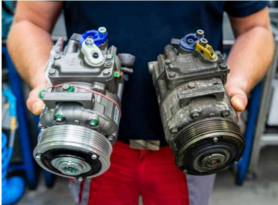
**Aus Alt mach Neu:** Links der fertig aufgearbeitete Klimakompressor, daneben ein verschlissenes Teil. Die Vorteile: Instandgesetzte Komponenten sind günstiger als neu angefertigte Ware und hinterlassen einen grüneren Fußabdruck, da dieses Verfahren einen Großteil der Energie und Rohstoffe einspart.
