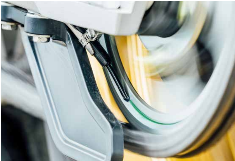
Weniger Verschleiß: Selbstregulierende Kettenöler verlängern die Laufleistung der Antriebskette um ein Vielfaches. Sie profitieren spürbar von der regelmäßigen Schmierung.
