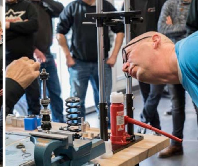
Schau genau: Kolbenringe und -stangendichtungen sind die am häufigsten zu wechselnden Verschleißteile. Im Motorrad-Haus erklärte YSS-Entwicklungsleiter Harrie Essens (l.), was dabei zu beachten ist. Damit Betriebe als Service-Center am Markt bestehen.
