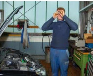
Frostschutzprüfer: Ein Blick durch das Refraktometer.
