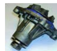
Werkstattfehler: zu viel Dichtmasse und Korrosion.
