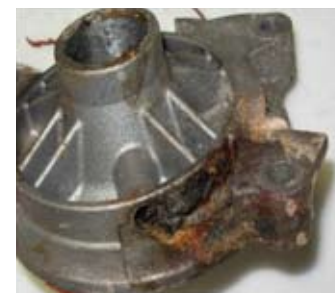
Werkstattfehler: zu viel Dichtmasse und Korrosion.
