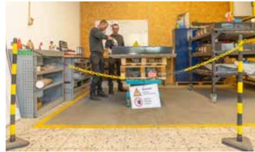
**Abgetrennter Raum:** Nur wenigen zertifizierten Werkstätten ist es erlaubt, an der Hochvoltbatterie der Streetscooter zu arbeiten. Hierfür hat der Betrieb eine separate Fläche eingerichtet.
