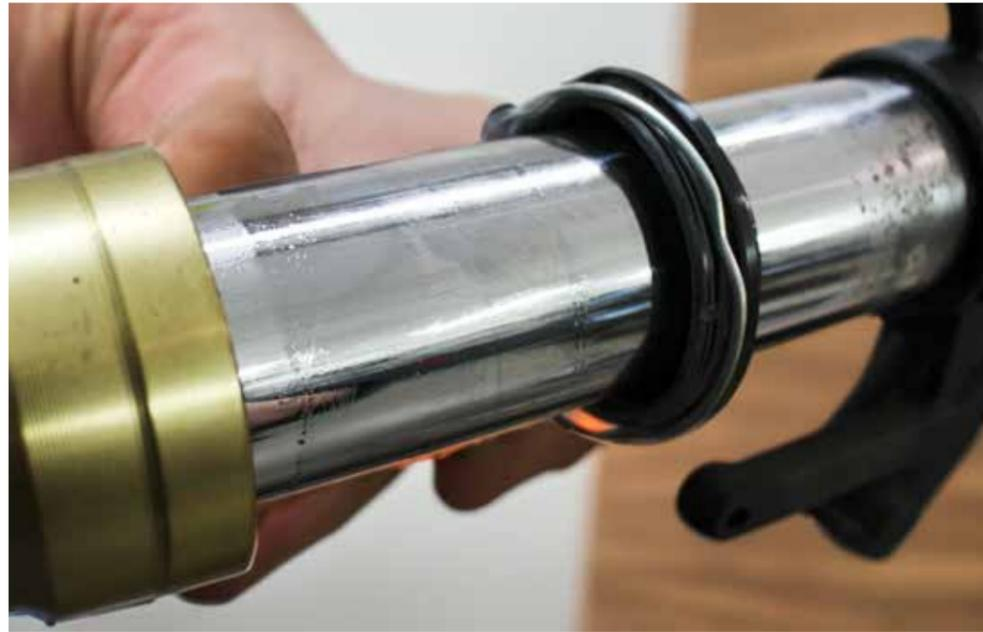
**Dieser steinschlagbeschädigte Simmerring** ist unbrauchbar und muss ausgetauscht werden. Auch Rost, Insektenreste oder andere Schmutzpartikel können sich an den Rohren festsetzen. Folge: Die Simmerringe werden im Laufe der Zeit undicht. Dies macht sich dann durch Gabelölverlust bemerkbar, was wiederum eine schwindende Dämpfung bedeutet.
