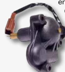
**Beispiel:** Dieser E-Choke von JMP kommt bei Morini-Motoren zum Einsatz.
