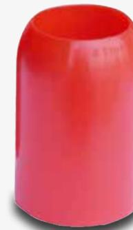
Mit diesem Werkzeug können Simmerringe schonend aufgezogen werden. Dazu setzt der Monteur die Montagehülse auf das Standrohr und schiebt den neuen Ring über die Montagehülse aufs Rohr. So wird der Simmerring nicht durch die Kante beschädigt.
