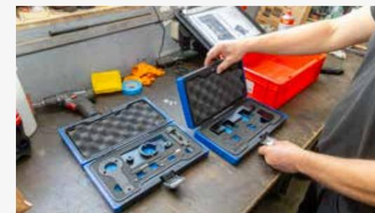
**Auspacken und losarbeiten:** Dieser Monteur hat den Werkzeugsatz für Einstellarbeiten am 2.0-CDTi-Motor eines Opel gemietet. **Preis: € 30,00 (3 Tage), JM-Nr. 614 30 85**
